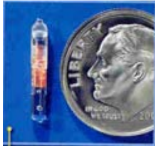
Fig. 13 Este chip es de 11 milímetros de largo y 1 milímetro de diámetro comparable a un grano de arroz. 123
