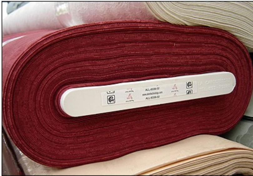
Etiqueta RFID usada en la Industria Textil. Fuente: ieee.org
