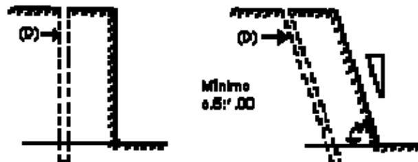
Fig. 9: Muestra esquemática de un frente de banco vertical y uno inclinado.
