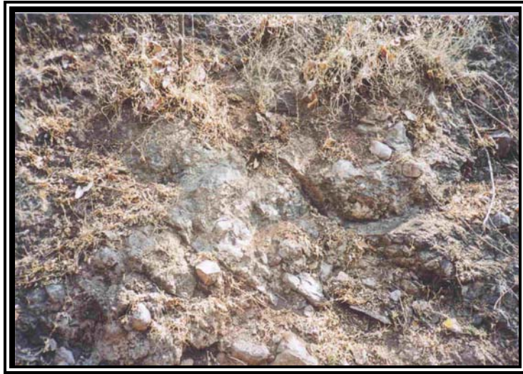
Fotografía 1.- En esta imagen se observa la pseudoestratificación y textura de la secuencia vulcanosedimentaria (Tvs) en la zona de descarga (cubeta deflectora) del vertedor.
