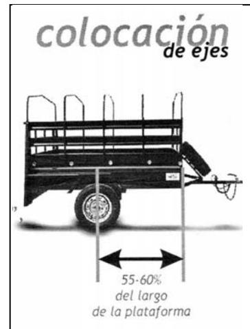
De esta manera se redefine la posición de los ejes y la distancia para realizar los cortes para las salpicaderas en la canal, como se muestra en la figura 3.4.
