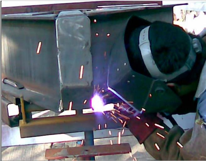
El chasis se remata al frente con la base de tirón, que como se mencionó, es una estructura hecha de perfil *ptr* de 4 pulgadas. Este conjunto antes de ser ensamblado es prearmado, pues deben unirse los tramos de *ptr* y la tapa que forman la base de tirón. Una vez realizado esto, se procede a ensamblarlo para formar parte del chasis del remolque.
