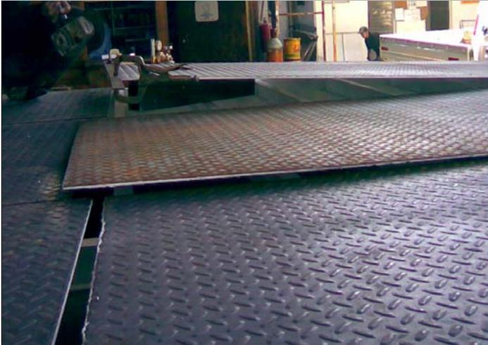
El piso de la cama es lo último que se arma, las placas se colocan en el orden que se mostró en la figura 3.2 y son soldadas por la parte inferior a los travesaños de canal de 3 pulgadas. Las placas deben ajustarse para que asienten correctamente sobre la estructura del remolque. En la figura 4.32 se muestra como se está llevando a cabo dicho ajuste.
