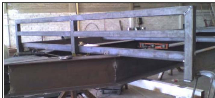
*Fig. 4.31 Ensamble de portería delantera.*
