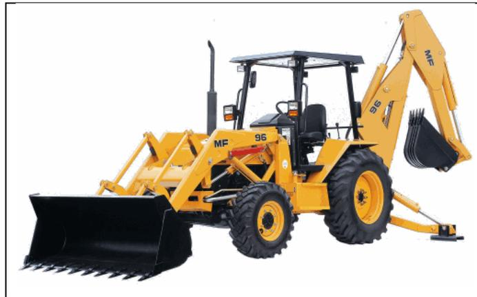
*Fig. 1.1 Retroexcavadora*
