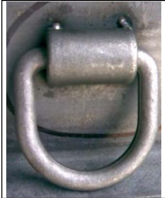
Los anillos son los elementos que se sueldan a las canales laterales y sirven para amarrar la carga y llevarla asegurada, ya sea con cuerdas o con eslingas. Los anillos seleccionados para el remolque se muestran en la figura 3.34.
