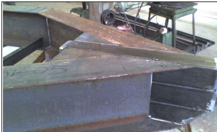
*Fig. 4.25* Base de tirón ensamblada en el chasis.
