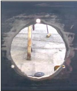
Las calaveras son las luces traseras que se colocan en la defensa del remolque haciéndole un barreno como el que se muestra en la figura 3.26. A ellas se conectan las líneas eléctricas de luces de freno, direccionales, intermitentes y cuartos.
