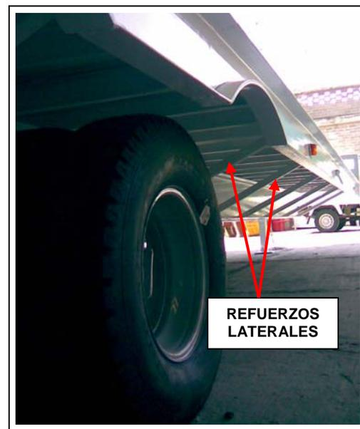
*Fig. 2.6 Parte inferior del remolque con nuevos refuerzos laterales.* >>>
