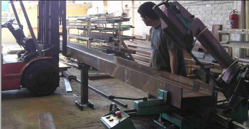
Fig. 4.21 *Vigueta de carga en proceso de corte*
