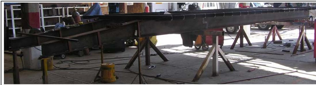
*Fig. 4.26 Chasis con travesaños ensamblados.*
