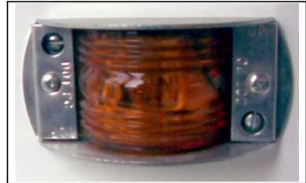
En cada costado del remolque se colocan dos luces laterales color ámbar, una al frente y otra en la parte central de la canal lateral, mientras que en la parte trasera, se instala una luz lateral roja. A dichas luces se conectan las líneas eléctricas de direccionales, intermitentes y cuartos.
