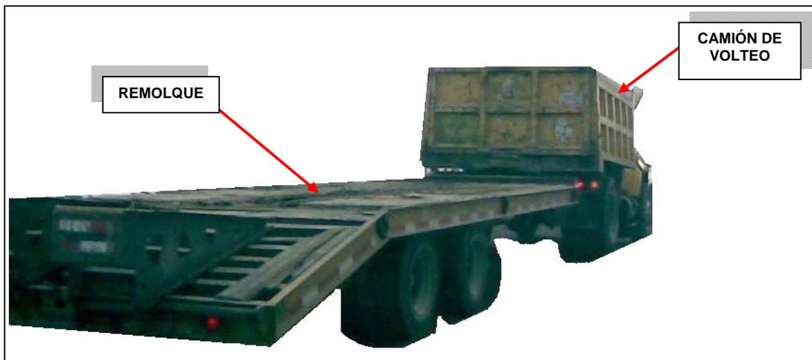
Fig. 1.3 Remolque de cama baja acoplado a camión de volteo.
