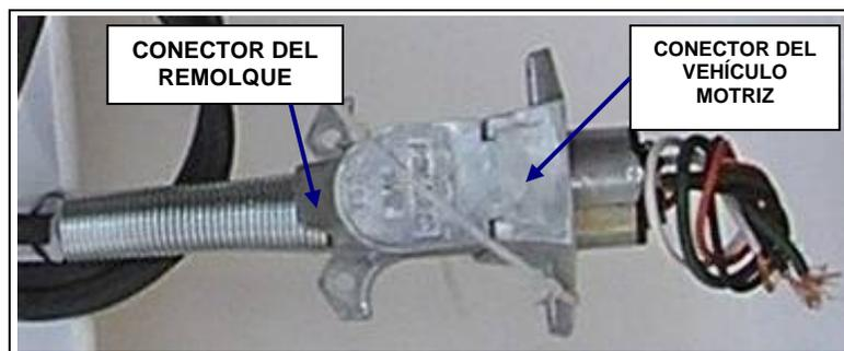
Fig. 3.30 Conectores de remolque y de vehículo motriz.
