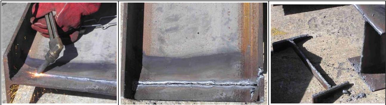
Fig. 4.10 Proceso de corte con equipo de oxicorte.
