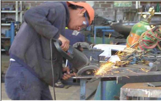
Una vez cortados los tramos según se necesite, es importante eliminar los filos que produce la sierra al cortar, esto es, retirar la rebaba; lo cual se realiza con una esmeriladora, tal como se muestra en la figura 4.18.
