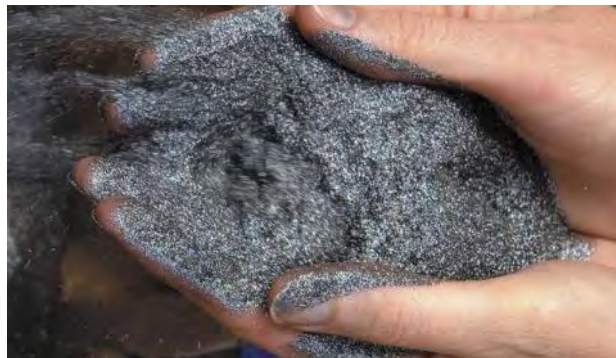
Figura 4. Óxido laminar de hierro, (Cortesía Mocayco ).
