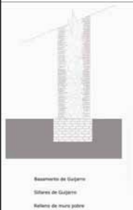
Corte en fachada de un muro fabricado con Guijarro durante la época novohispana.
