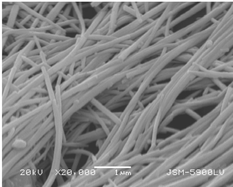
**Figura 4.20** Micrografía de la zeolita natural, ZN (20 000 X).
