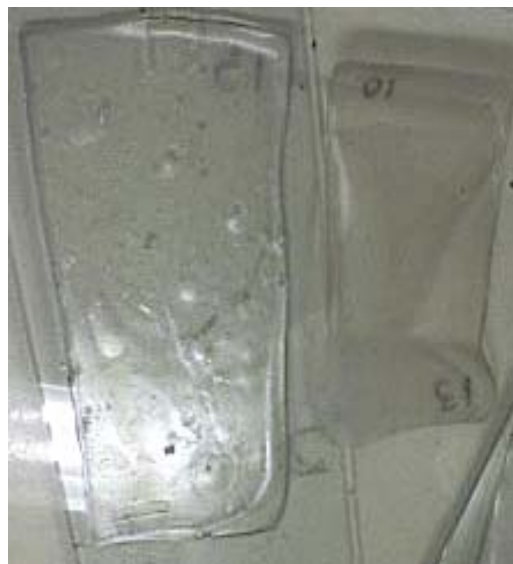
Figura 25. Efecto de tolueno sobre nanocompuestos látex natural (a)0.0pcr MMT (b)7.5 (izq) y 10.0pcr (der)
