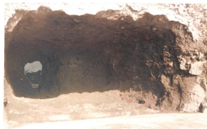
En esta foto se observa el nivel freático del P.C.A. No. 3, el cual se detectó a 2.00 m de profundidad.
