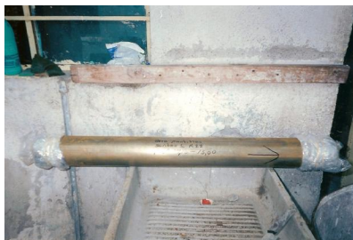
Muestra inalterada, muestreador shelby
