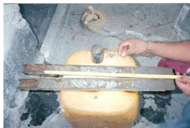
Muestra alterada, muestreador shelby
