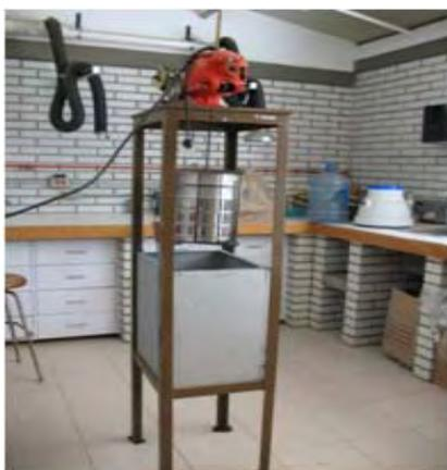
Foto 1. Equipo automatizado (con motor) para sumergir los tamices.
