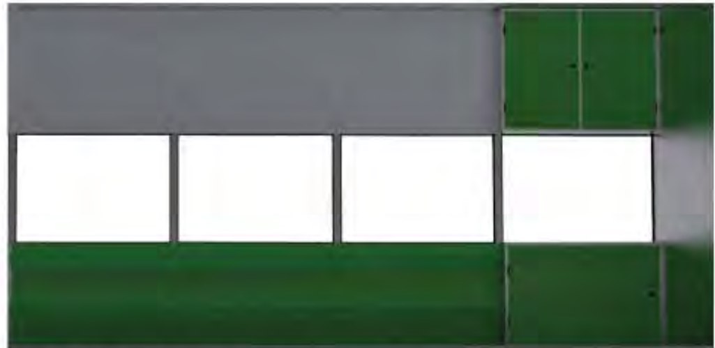
Repisas y lockers interiores. Muebles de guardado para componentes del sistema de iluminación y repisas para poner objetos personales de usuarios o pequeña biblioteca
