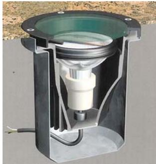
Luminaria de empotrar en piso para lámpara halógena. 75w, cuerpo de fundición de aluminio, tapa en fundición de aluminio a presión, acabados en poliéster micropulverizado de aplicación electrostática, cristal templado de 6 mm. con sello de alta temperatura. marca philips mod. 95/82-M
