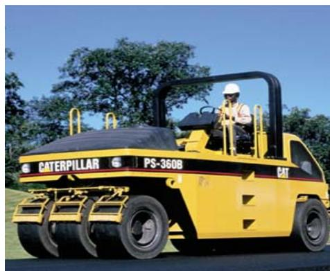
Fig. 13.- Compactación con rodillo neumático.
