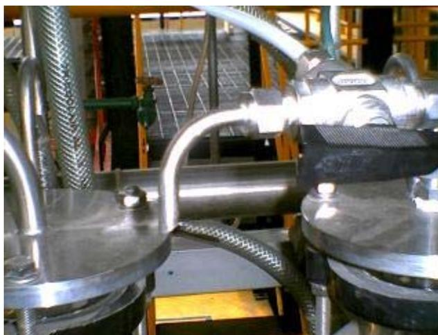
**Figura 3.07.** Válvula de muestreo de destilado.
