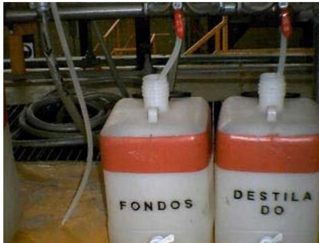
Figura 3.11. Tanques de destilado y fondos.
