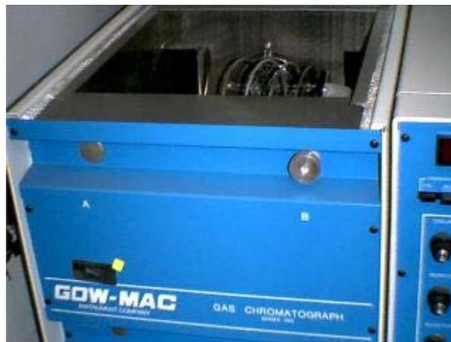
**Figura 3.14.** Cromatógrafo de gases.
