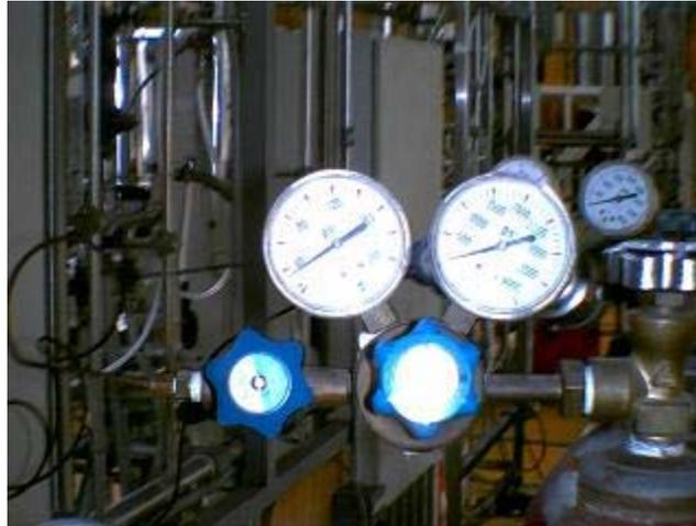
**Figura 3.16.** Válvulas de control y reguladores de presión de los tanques de alimentación del cromatógrafo.
