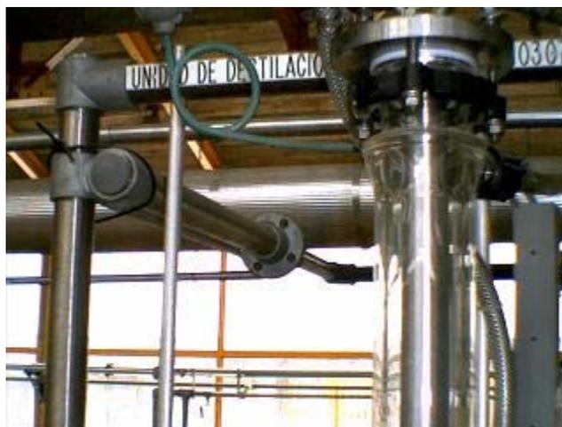
**Figura 3.03.** Condensador.
