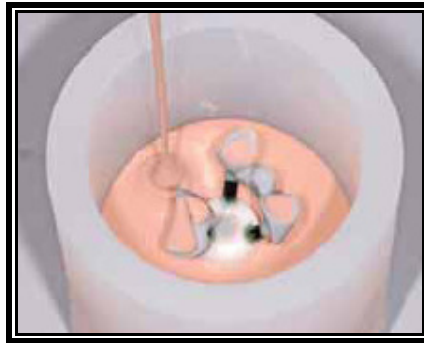
Figura 17. Colocación del revestimiento. 25
