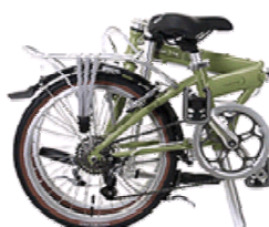
Figura 38. Ej. de plegado mediante bisagra a la mitad del cuadro.
