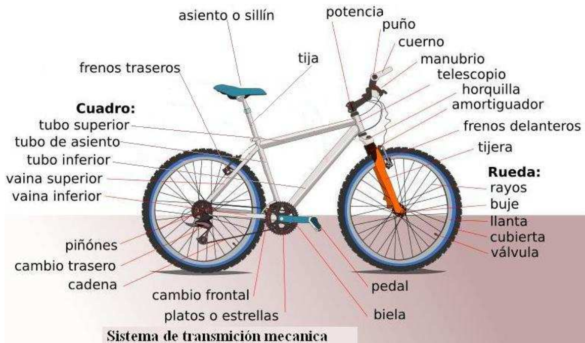
Figura 11. Sistemas y componentes básicos de la bicicleta. [15]
