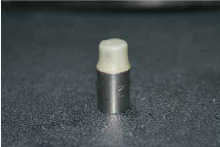
5.- En el bloque de resina se dibujó el ecuador con lápiz y se cortó el interior de éste.
