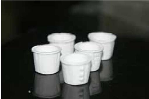
14.- Se introdujo los núcleos 10 segundos en el Colour Liquid y se secó con aire
