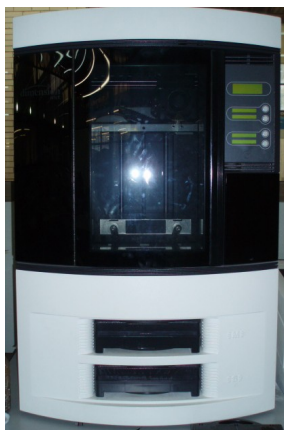
Figura 5.6 Fotografía de la máquina de prototipos rápidos Stratasys Dimension .
