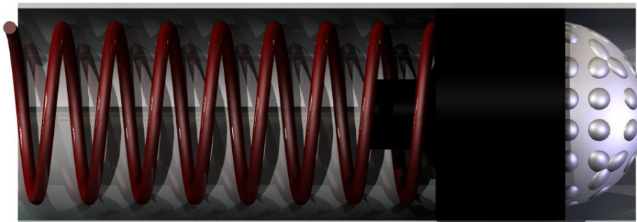
Figura 3.2 Sistema de disparo a base de un resorte de compresión.
