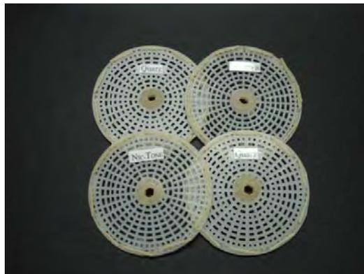
Los discos de plástico fueron previamente ajustados por su centro con acrílico autopolimerizable a una barra metálica que sería la encargada de soportar los cuatro discos de plástico con los 80 especímenes de estudio. (fig.7)
