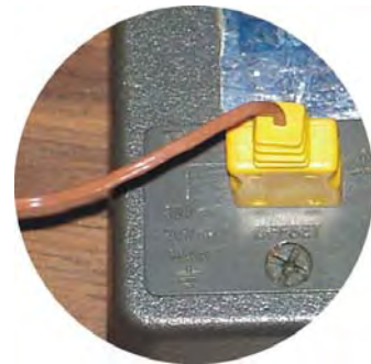
Foto 9. Conectores mini-termopar del termómetro.
