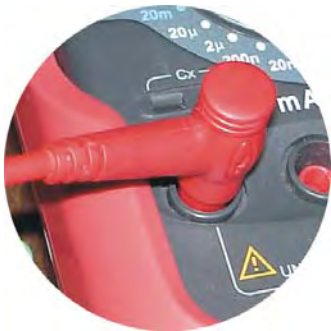
Foto 8. Conectores banana del amperímetro.
