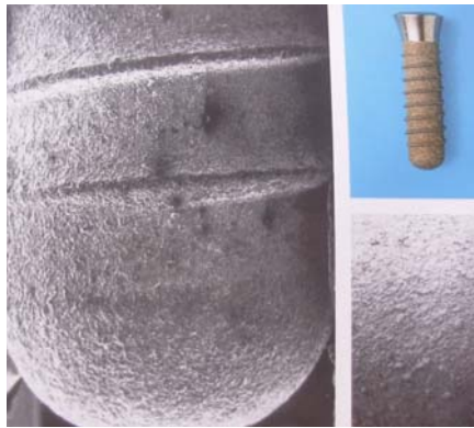
Fig(16). Implante de tornillo ITI-Bonefit con revestimiento de plasma de titanio (6)
