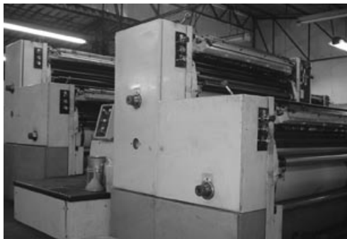
Offset para impresión de 4 tintas
