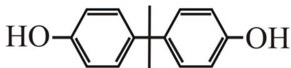
Fig. 5. Estructura química del bisfenol A (2,2-bis-4-hidroxifenil propano).
