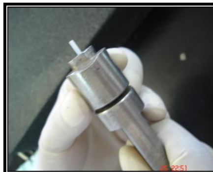
Fig. 92. Vástago atornillable donde se coloca la muestra.
