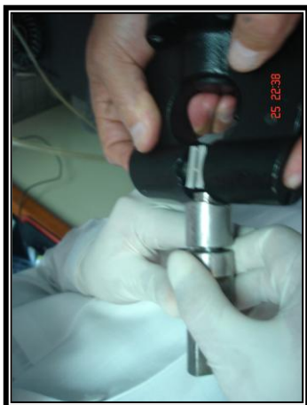
Fig. 93. El cilindro se coloca en el aditamento de pinza a presión.
