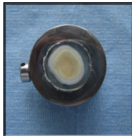
Figura 3. B Preparación de la muestra al confinar con acrílico
