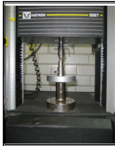
Figura 15. B Muestra colocada en máquina Instron.
