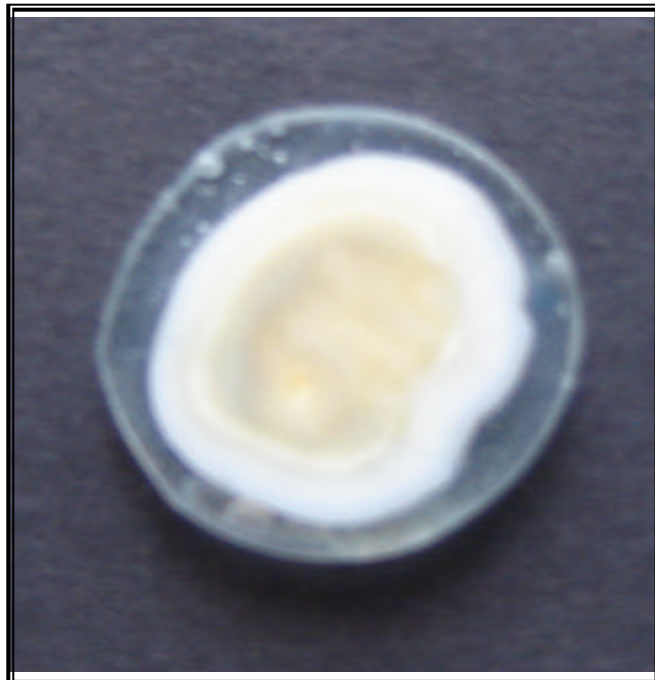
Figura 4. B Muestra pulida por sus dos caras
