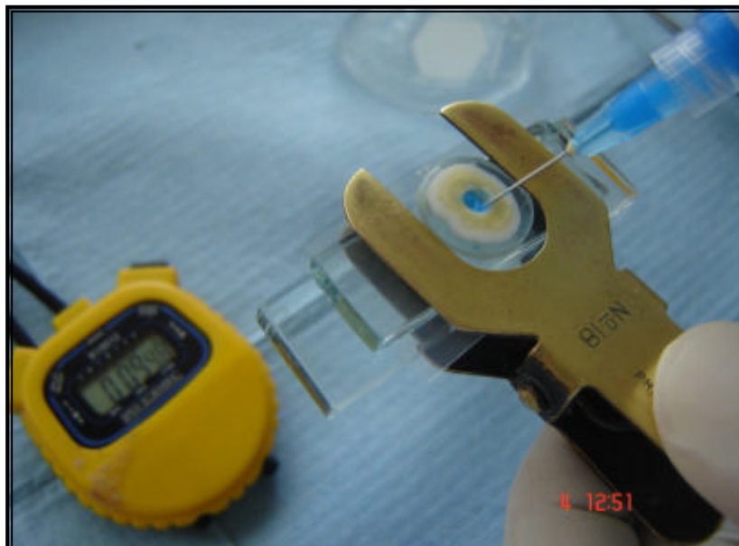
Figura 10 Acondicionamiento de la cavidad 15s
