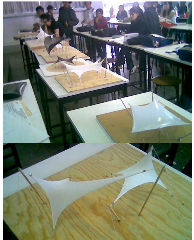
Fig. 77 y 78- Maquetas previas, al ejercicio final de velarias. Se nota la experimentación con materiales flexibles, por lo regular adaptándose a la geometría el PH. Fotos de Carolina Carmona D.R.
