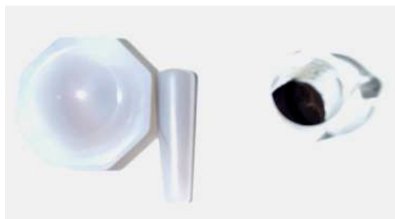
Figura 16. Óxido de cobre después de la moliendo a temperatura ambiente
