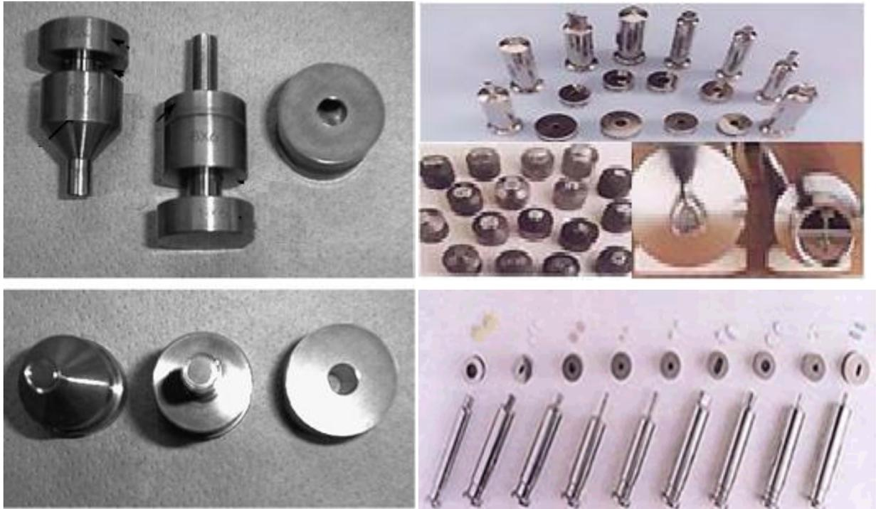
Fig.16 Matriz y punzones de prensa hidráulica. <sup>37,13</sup>
