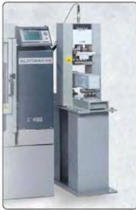
Bastidor de 100 kN de capacidad con rodillos, célula de carga y juego de conexión para consola de control independiente
