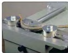
Detalle del enderezamiento
