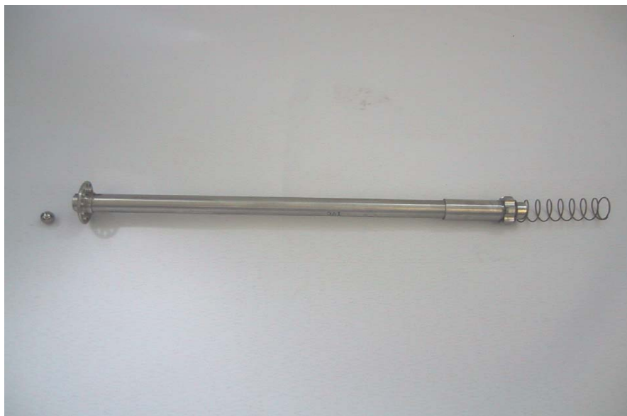
Figura 2.4: Cilindro a través del cual se desplaza el balín en el viscosímetro
