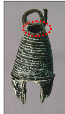
Figura 11.42. Cascabel con defecto de fundición (cascabel 3-sn-3)
