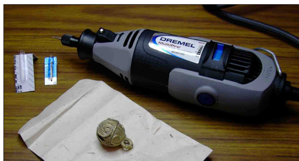
Figura 9.28. Taladro con fresa de dentista con cabeza de diamante. El cascabel es artesanal contemporáneo y no forma parte de la colección de los cascabeles de la Bodega de Decomisos.
