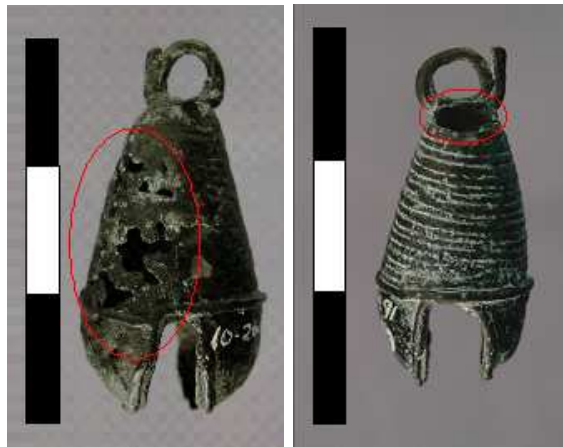
Figuras 8.18. y 8.19. Falta de fundición en cascabeles Periformes (cascabeles 3-sn-25 y 3)
