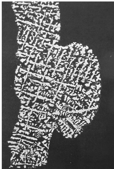
Figura 11.44. Pared y cinturón de un cascabel de cobre-arsénico (12.28 % As). Atacado con dicromato de potasio y ácido hidroclicórico (de Hosler 1994a:136)
