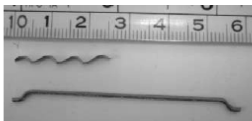
Fig. 1 Fibras utilizadas en este estudio, identificadas como: D (lisa con ganchos en los extremos, 60mm de longitud) y N (ondulada, 25 mm de longitud).
