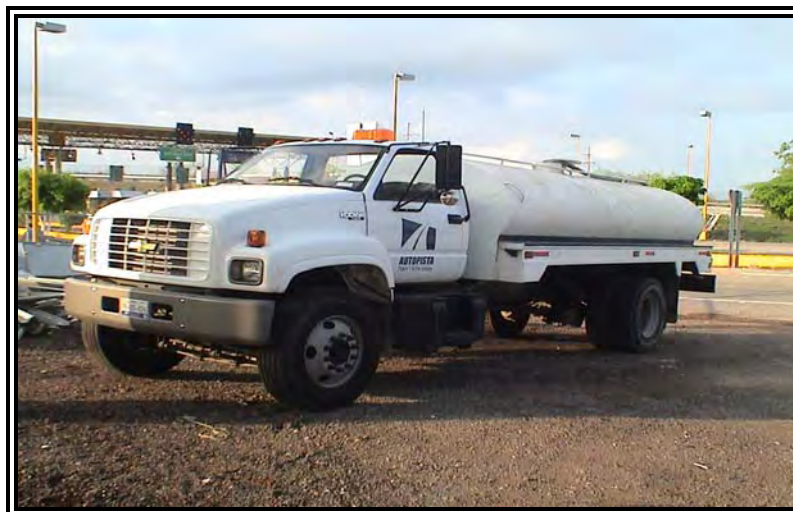
Figura 41. Pipa de 10,000 litros de almacenamiento de agua
