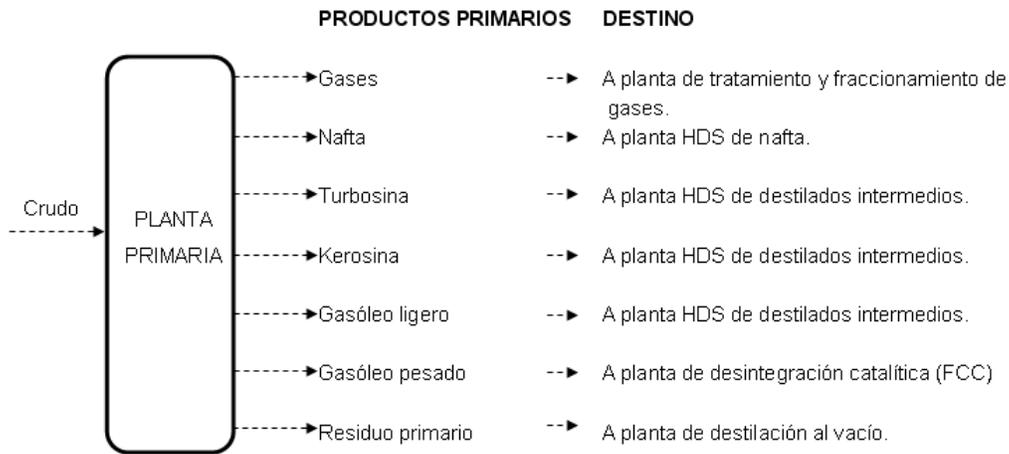
Figura 1.2. Proceso de destilación atmosférica en la refinería.
