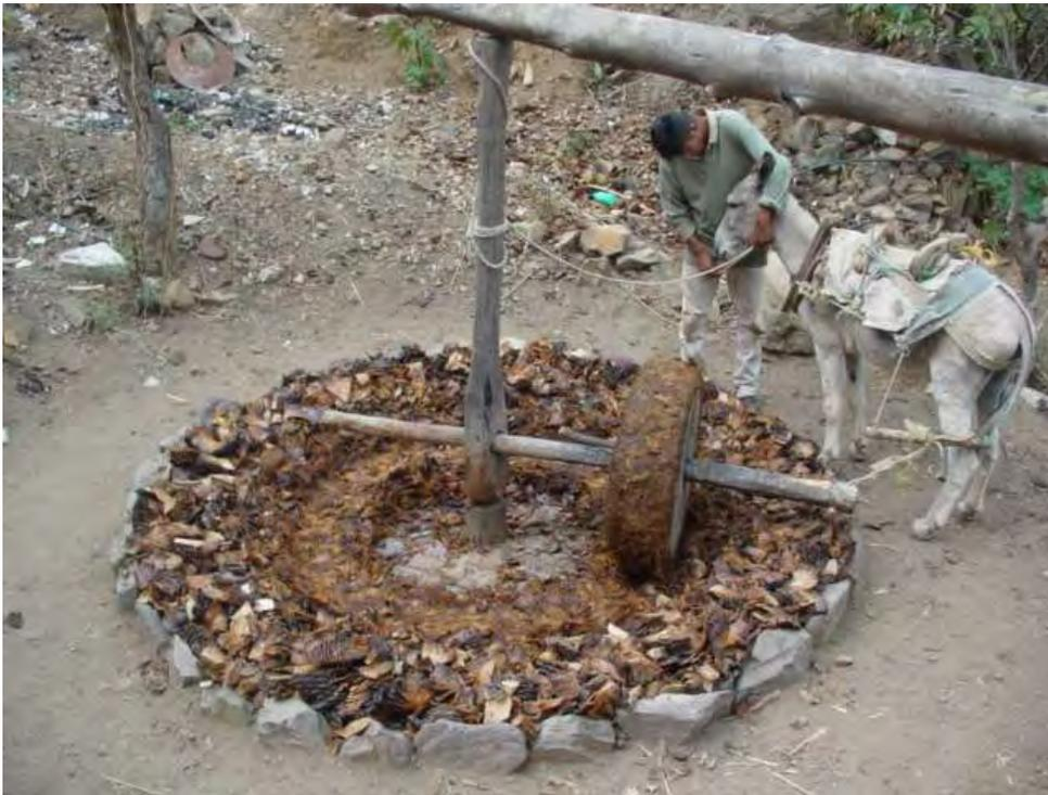
**Figura 16. Forma mecánica de triturar el maguey mediante una era o molino mecánico. Mecanismo giratorio que atraviesa por su centro una gran rueda hecha de cemento y piedras y que es accionada por un burro. Al tirar, la rueda tritura las piñas de maguey previamente cortado en trozos.**
