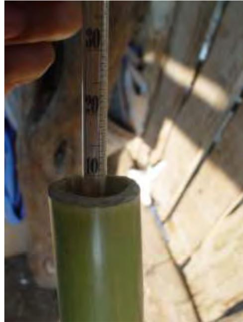
**Figura 25. “Pesalícor” o alcoholómetro (foto autor anónimo) empleado para medir y regular la graduación alcohólica del mezcal, el cual se pone en un recipiente de carrizo y se introduce el pesalícor (foto América Delgado Lemus).**
