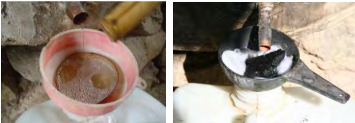
**Figura 23. Dos formas de filtrar el mezcal para eliminar basuras y restos de cobre, izquierda empleando una jícara y derecha empleando un carbón sobre un paño.**
