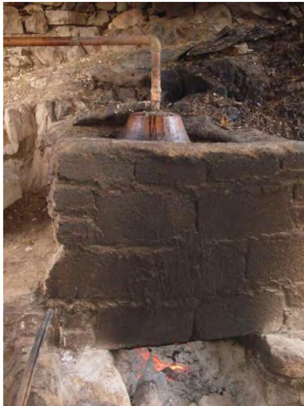
**Figura 22.** Alambique con montera de cobre.
