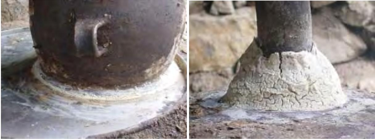
**Figura 21.** La masa para tortillas es empleada para sellar ranuras o grietas al momento de ensamblar la montera, parte del alambique que se acopla sobre el tambo donde se hierve el tepache y el turbante.
