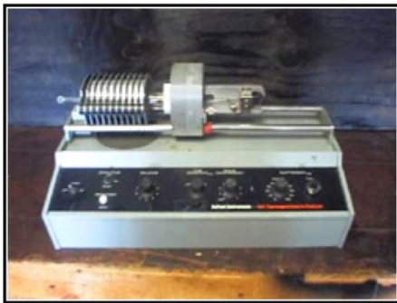
Figura 4. Imagen del equipo de TGA empleado para el análisis de las muestras ( http://www.bamko.com/lab/dla090603q.jpg ).
