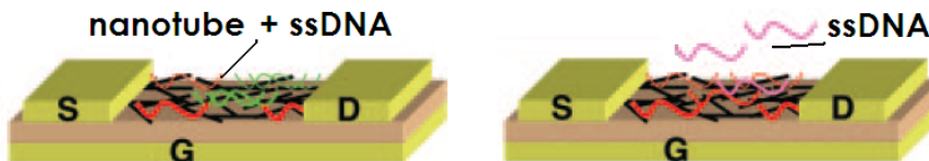
Figura 7. Transistor hecho a base de SWNTs capaces de reconocer secuencias específicas de genes a través de su hibridación [11].
