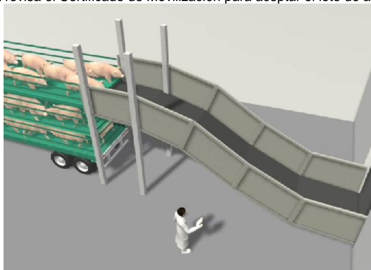
Imagen 8. Rampa portátil inclinada para descender los cerdos, el material de la rampa debe ser de material antiderrapante para evitar que resbalen los animales.
