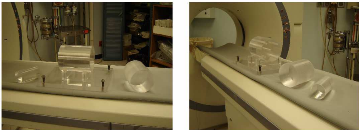
Figura 4.9. Maniqués fabricados en el taller del Instituto de Ciencias Nucleares para la medida del K_{PMMA} , de C_W^{Cam} y C_W^{TLD} .
