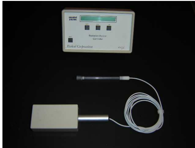
Figura 4.2 Cámara de ionización tipo lápiz diseñada especialmente para medidas en CT.
