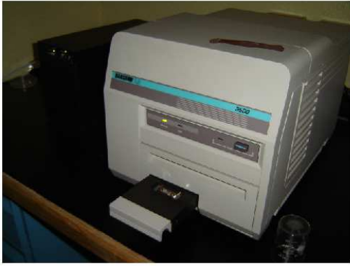
Figura 4.4 Lector termoluminiscente Harshaw 3500, con el que se obtiene la señal termoluminiscente de los TLD-100.
