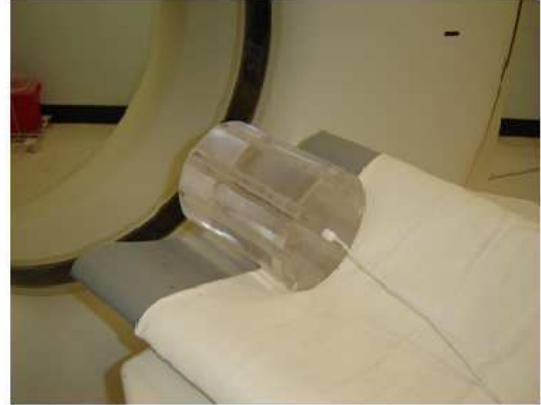
Figura 4.13 Montaje experimental de la cámara de ionización colocada dentro del maniquí y en el tomógrafo para medir C_W^{Cam} .
