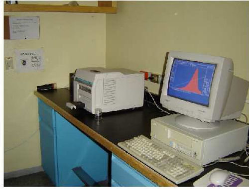
Figura 4.4 Lector termoluminiscente Harshaw 3500, con el que se obtiene la señal termoluminiscente de los TLD-100.
