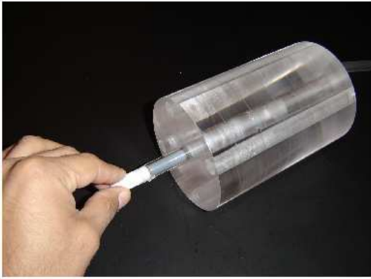
Figura 4.13 Montaje experimental de la cámara de ionización colocada dentro del maniquí y en el tomógrafo para medir C_W^{Cam} .
