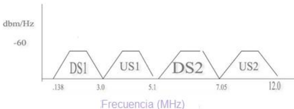
Figura 3.11 Localización de frecuencias para ETSI Plan 997
