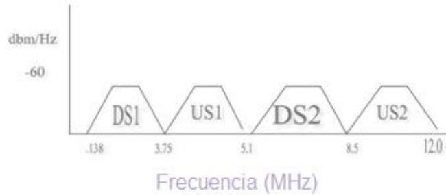
Figura 3.12 Localización de frecuencias para ETSI Plan 998
