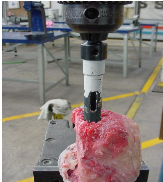
Figura 4.1 Sacabocados para extracción de muestra cilíndrica
