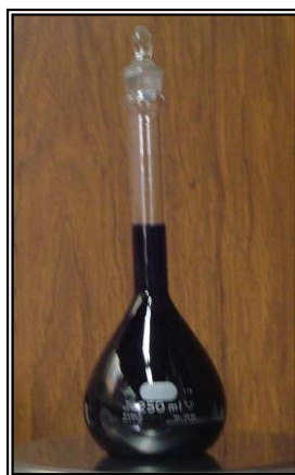
Figura 26: Amina cúprica preparada a 0.25M.
