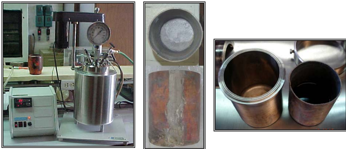
Figura 30: Equipo autoclave completo, incluyendo el detalle del inserto de plomo.
