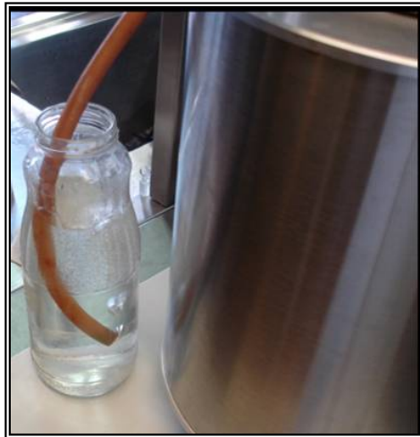
Figura C3: Lavado de gases durante la despresurización de la autoclave.
