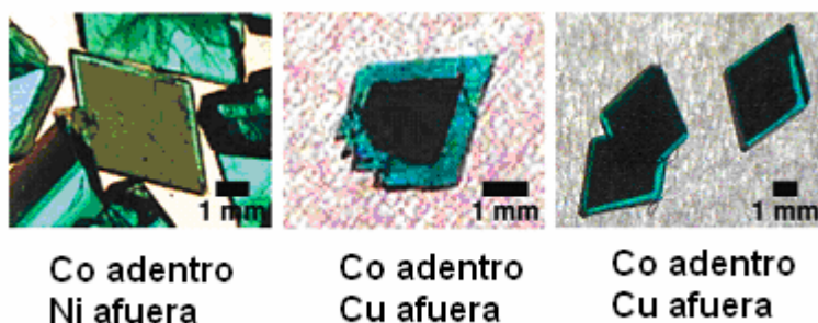
Fig. 12. Cristales compuestos utilizando como semilla el complejo de Co en soluciones de Ni y Cu. [4]
