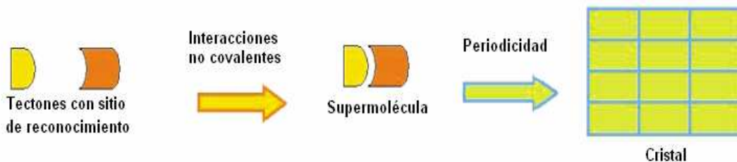
Esquema 1. Pasos de la formación de un cristal a partir de tectones.
