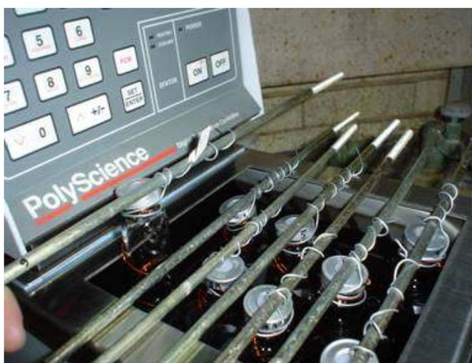
**Fig. 3.13** Polimerización en viales dentro de un recirculador.
