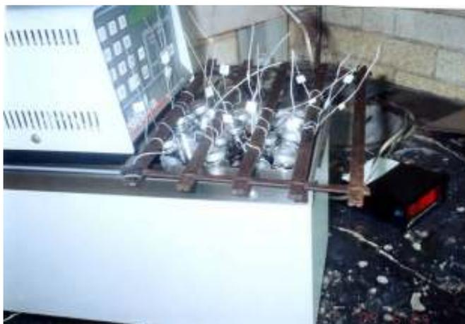
**Fig. 3.5** Polimerización en viales llevada a cabo en un recirculador en FQ-UNAM.
