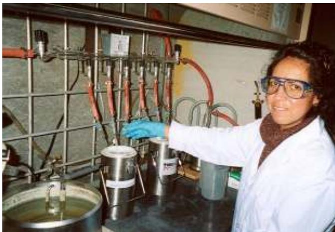
**Fig. 3.8** Línea de vacío utilizada para desgasificar las ampollitas en el IPR-UW.
