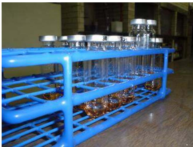
**Fig. 3.11** Viales de Head space en los que se lleva a cabo la polimerización.
