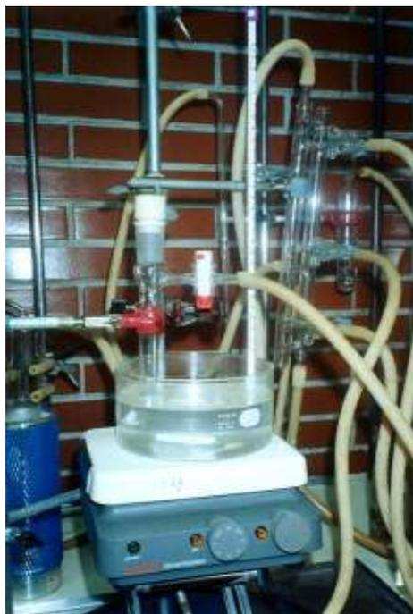
Fig.3.4 Polimerización en equipo Schlenk del IIM-UNAM.
