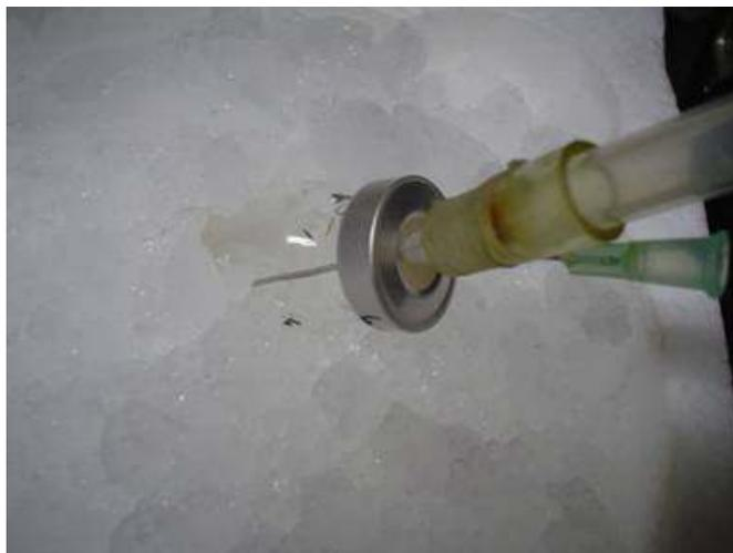
**Fig. 3.12** Inyección de nitrógeno en un baño de hielo para condensar el estireno evaporado.
