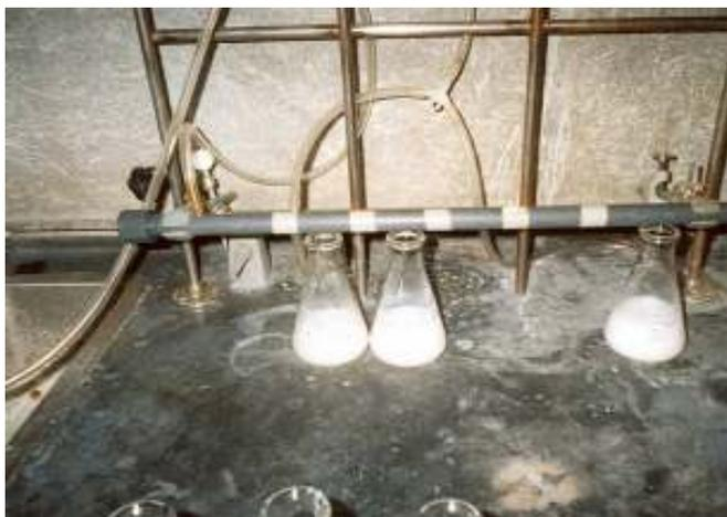
**Fig. 3.10** Eliminación de etanol y diclorometano con una línea de aire en el IPR-UW.
