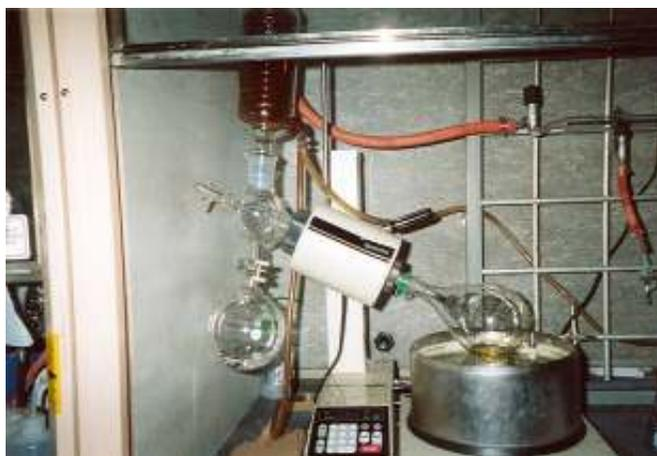
**Fig. 3.3** Destilación de estireno en el laboratorio del IPR-UW.
