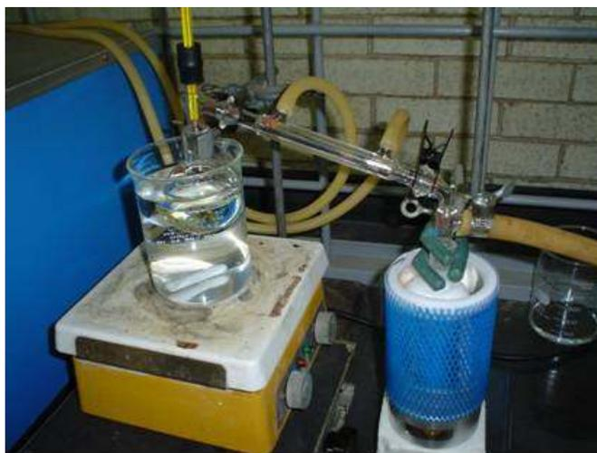
**Fig. 3.1** Destilación de estireno a vacío en el laboratorio de la FQ-UNAM.
