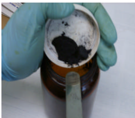
Figura 3.4. \text{K}_2\text{FeO}_4 sintetizado y guardado en frasco color ámbar
