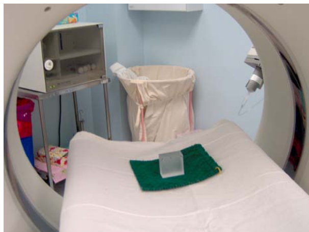
Figura 3.7. Colocación de la muestra de lucita en el tomógrafo (colocada en el plano XY).
