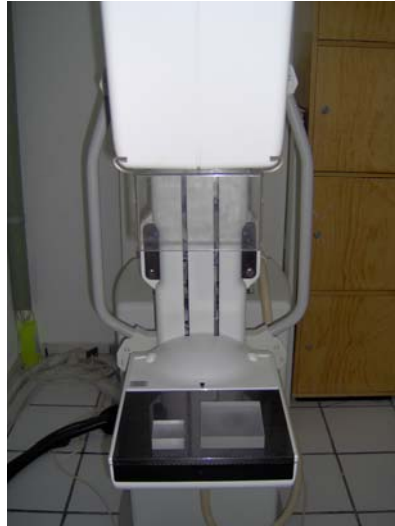
Figura 3.3. Colocación de las muestras de lucita en el mastógrafo.
