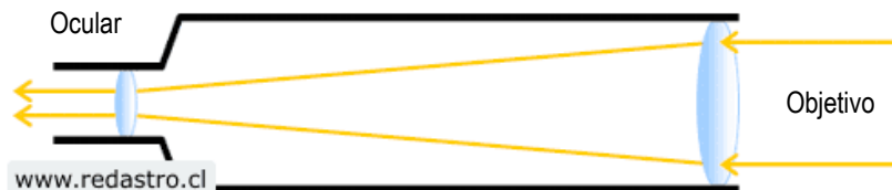
Fig. 5.5 Camino óptico de un telescopio refractor
