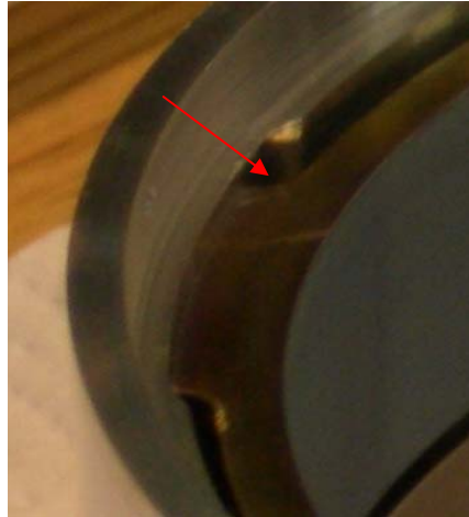
Fig. 7.3 Detalle de la Figura 7.2, en ella se puede observar la ranura hecha a la celda mediante electroerosión, este es una de las características que se quiere optimizar.
