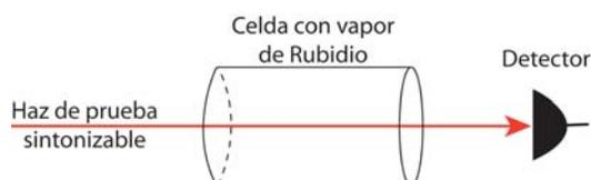
Figura 30: Esquema de la espectroscopia de absorción.
