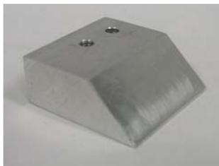
**Figura 46:** Montura para la rejilla de difracción holográfica.
