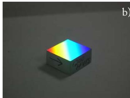
**Figura 15:** a) Origen de la interferencia constructiva producida por una rejilla de difracción. b) Rejilla real dispersando en varios colores luz natural.
