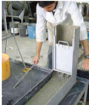
*Fig. 3.15 Caja L con concreto.*
