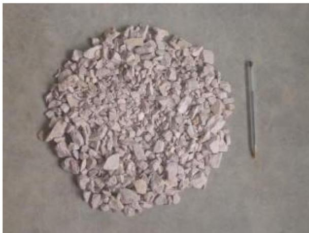
*Figura 1.3 Grava caliza de 19 mm (3/4”).*
