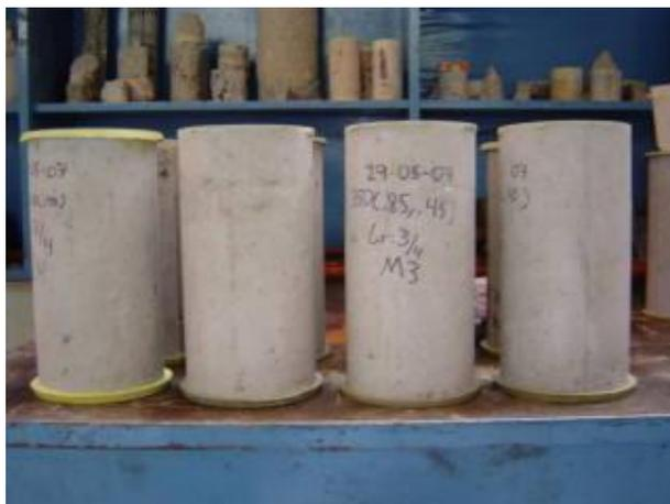
*Figura 4. Probetas de concreto autocompactable.*
