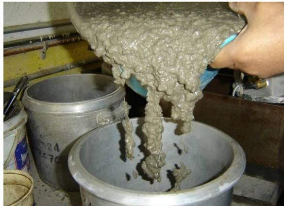
*Fig. 3.5 Concreto autocompactable en estado fresco.*
