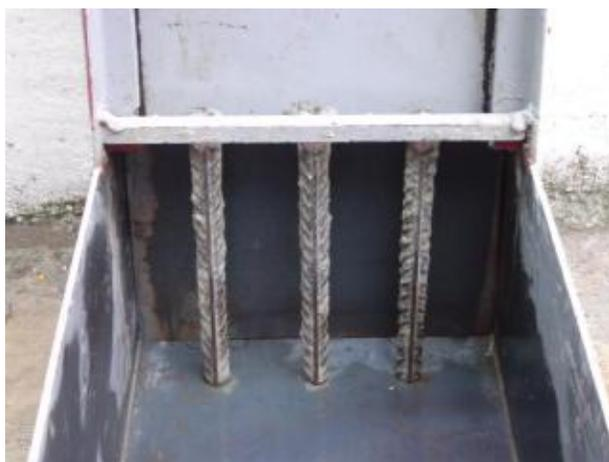
*Fig. 3.12 Caja L con tres barras de refuerzo.*
