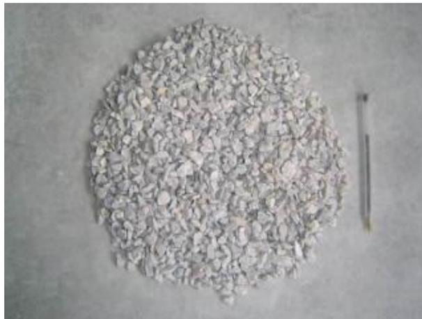
*Figura 1.5 Grava caliza de 9.5 mm (3/8”).*
