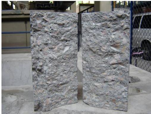
*Fig. 4.20 Cilindro de concreto después de la prueba.*
