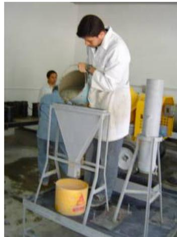
Fig. 3.23 Embudo V siendo llenado con concreto.
