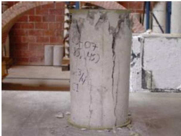
*Figura 4.1 Cilindro de concreto después de ser ensayado.*
