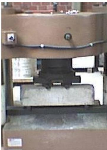
*Fig. 4.13 Prueba de tensión por flexión en vigas.*
