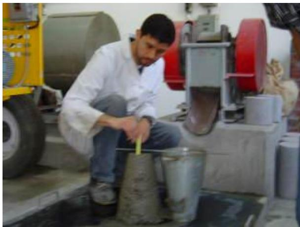
*Fig. 3.1 Medición del revenimiento.*
