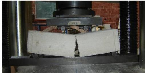
*Fig. 4.15 Prueba de tensión por flexión en vigas.*
