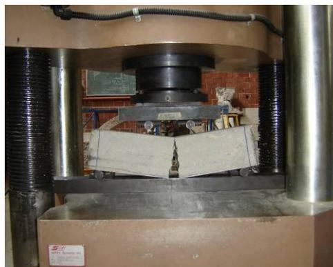
*Fig. 4.14 Prueba de tensión por flexión en vigas.*
