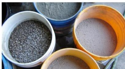
*Figura 1.2 Agregados empleados en la fabricación de concretos autocompactables.*
