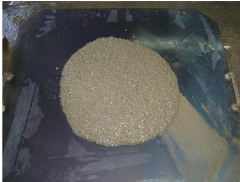
*Figura 3. Concreto autocompactable en estado fresco.*
