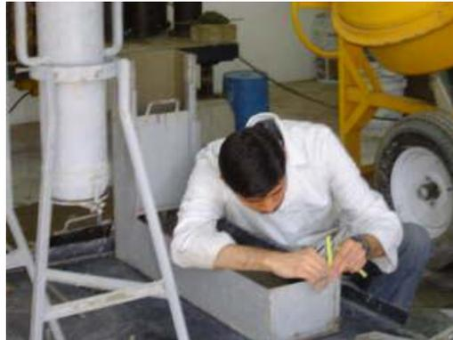
*Fig. 3.16 Medición de alturas en la caja L.*
