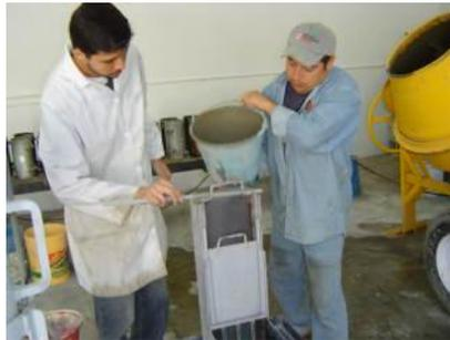
*Fig. 3.14 Caja L siendo llenada con concreto.*
