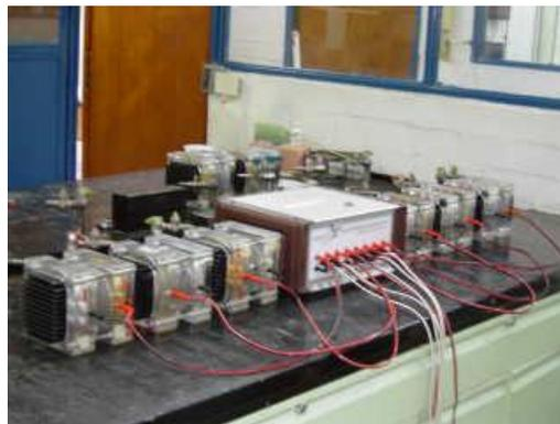
*Fig. 4.23 Dispositivo utilizado en la prueba de permeabilidad a los cloruros.*
