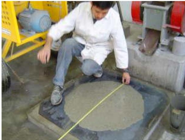
*Fig. 3.9 Medición del diámetro final del concreto.*
