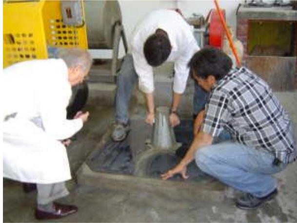
*Fig. 3.8 Levantamiento del cono de Abrams.*
