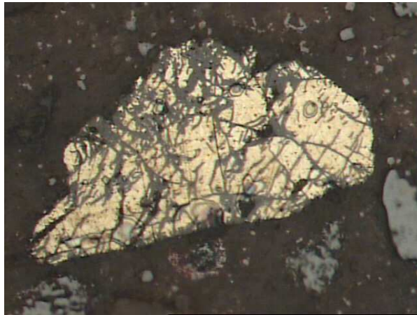
Figura 29. Jales antiguos de color rojo (muestra JCH- VB). Donde se observa una partícula mixta subangulosa de pirita muy fracturada, con remplazamiento parcial por oxihidroxidos de Fe, a través de sus bordes y sobre todo en las fracturas. Fotografía tomada con luz paralela.
