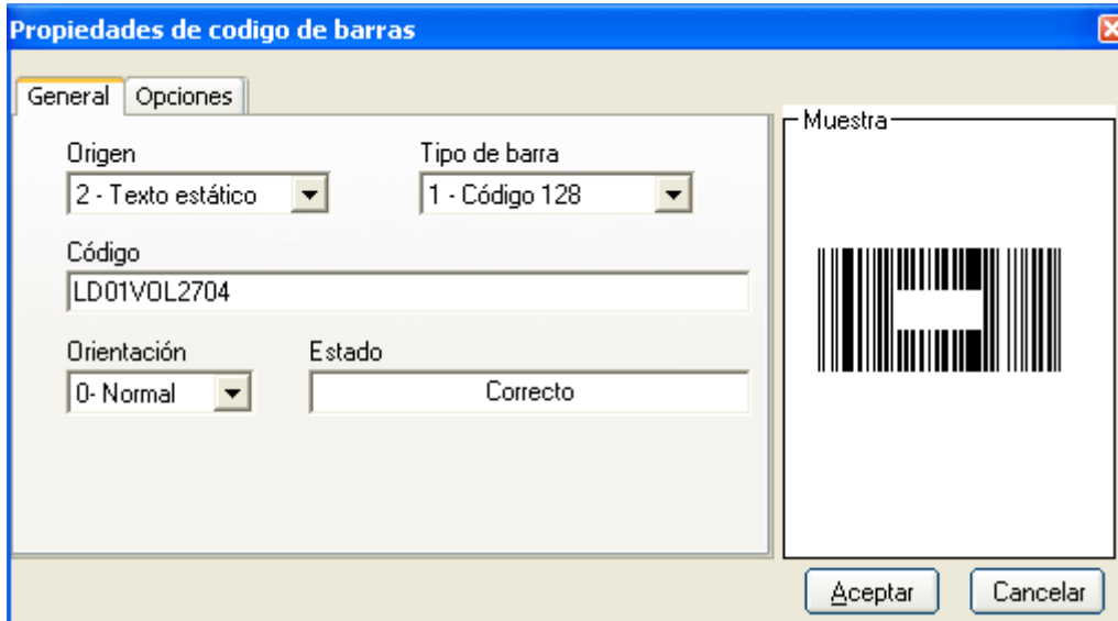
Figura 26. Ingreso del código de identificación de un contenedor para ser traducido al formato 128 de un código de barras.
