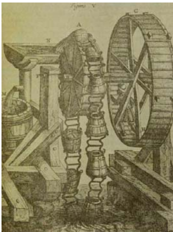
Máquina “malacate” para desaguar las minas
